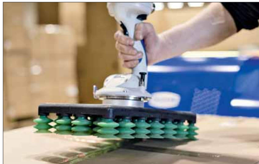
Mit dem Multigreifer handhabt der Anwender Kartons unterschiedlicher Größen und Qualitäten sicher.
