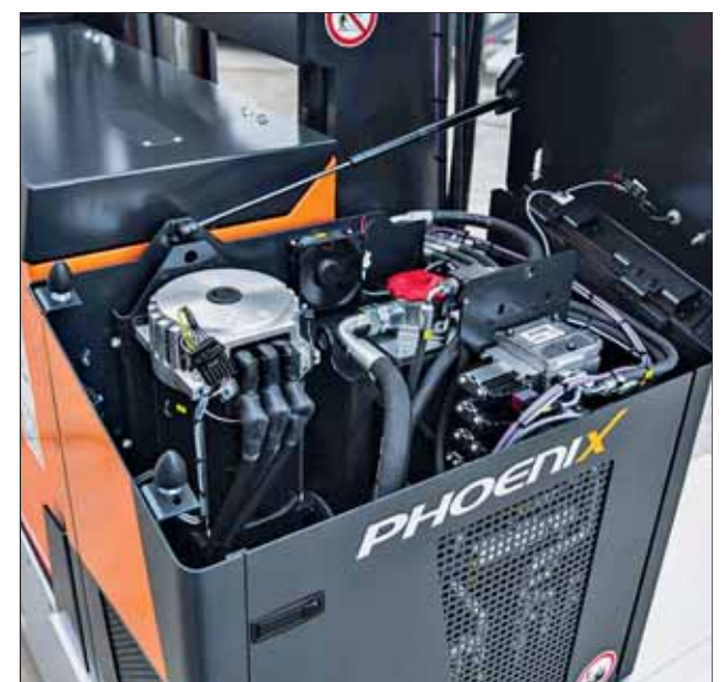
Zu den weiteren Verbesserungen gehört der Betrieb mit reduzierter Geräuschemission dank einer speziellen Hydraulikpumpe, der „Silencepumpe“. Fotos: Hubtex
